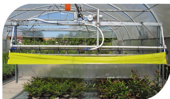
Figure 1 : Robot multifonction, arrosage, traitement, stimulation et piégeage massif.
